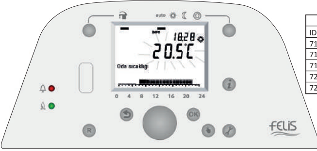
Şekil 16. Konfor Ayar Değeri Ayarlanması
